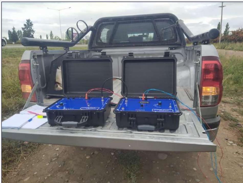
Servicio de geofísica-Método Geoeléctrico
