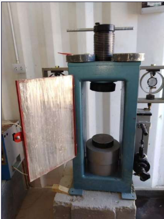
Ensayo de Rotura de Probetas De Hormigón
