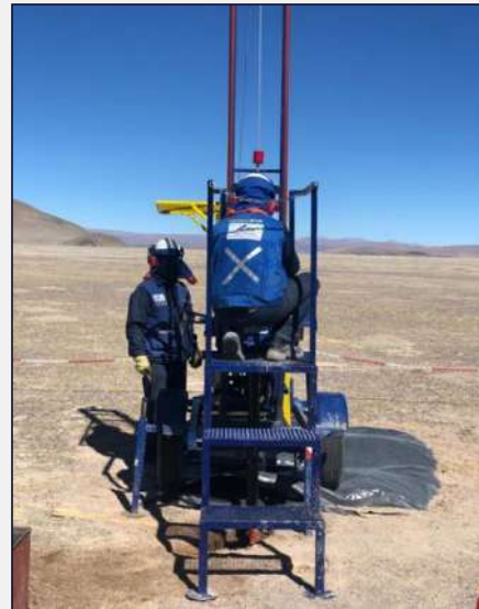
Servicios de Perforación y ensayos SPT – Caracterización de suelos
