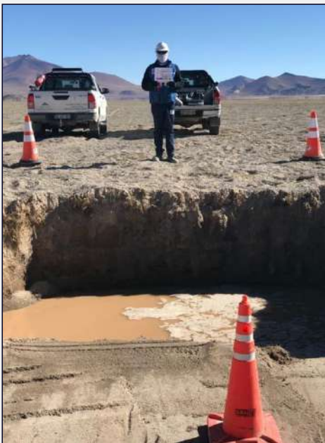
Servicios de Caracterización de suelos mediante calicatas-Ensayo de Densidad
