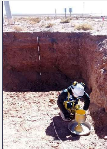
Servicios de Caracterización de suelos mediante calicatas-Ensayo de Densidad
