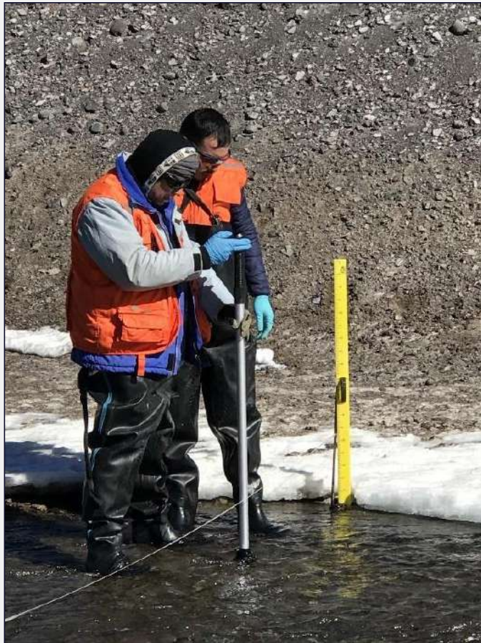
Aforo de Ríos- Medición de Caudal
